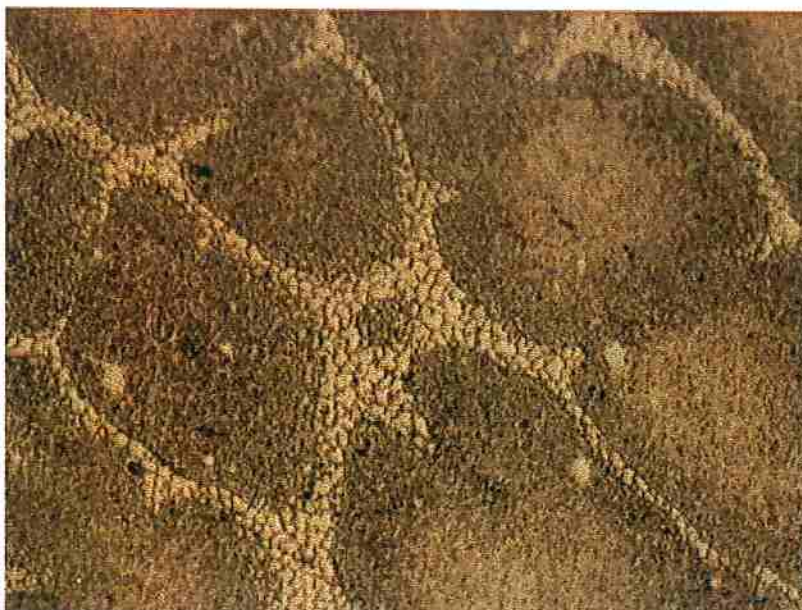
Figura 27: Amostra 10 (79,46 at% Ni). Presença da fase primária \gamma e do constituinte eutético interdendrítico \gamma + \gamma' . Aumento: 500x
