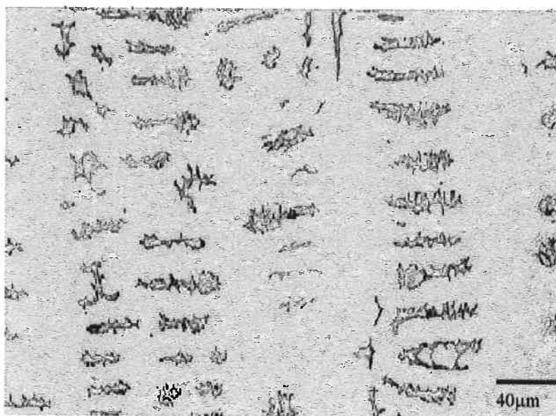
Figura 24: Amostra 5 (74,06 at% Ni), apresentando constituinte primário \beta e fase contínua \gamma' . Imagem de elétrons secundários.
