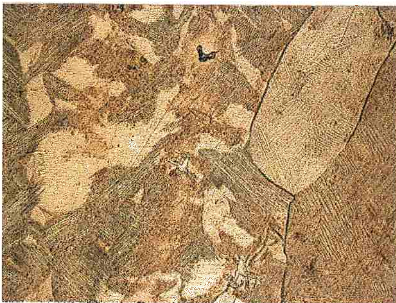
Figura 23: Amostra 2 (64,93 at% Ni), apresentando estrutura martensítica Aumento : 200x
